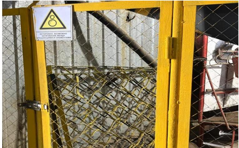
Ограждение вращающихся элементов печи и ленточного транспортёра с установкой концевого выключателя, что обеспечивает автоматическое отключение вращающихся элементов при открытии калитки ограждения;
