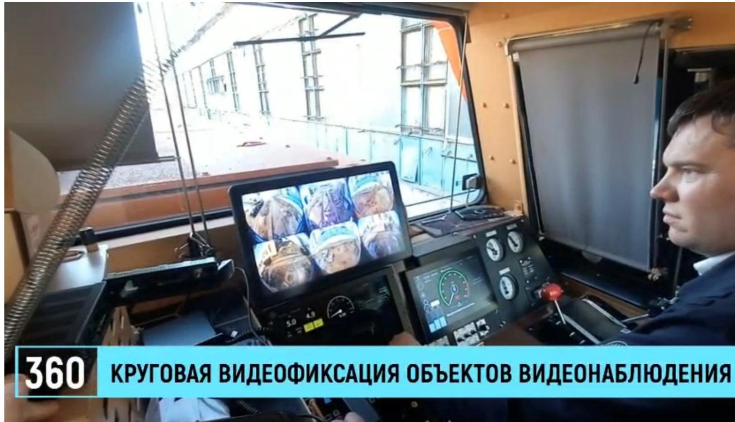
«Система кругового обзора 360°» (далее – СКО) вокруг маневрового тепловоза предназначена для исключения попадания человека в слепую зону, находящегося в периметре движения тепловоза. А также для облегчения контроля машинистом локомотива за работниками, участвующими в процессе маневровых передвижений.
